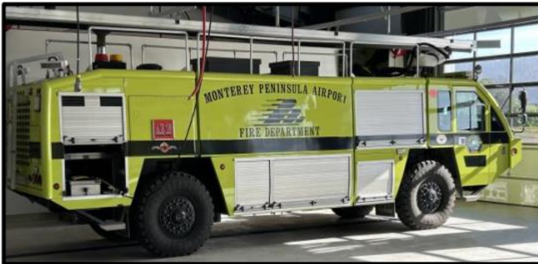
Motor AR16 de Rescate y Extinción de Incendios de Aeronaves (ARFF, por sus siglas en inglés) en el nuevo parque de bomberos de la zona norte del MPAD
